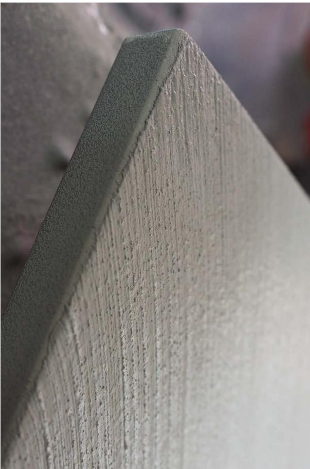
Questa opera manifatturiera praticata da personale specializzato è costituita da una resina cementizia composta da una resina acrilica monocomponente all'acqua applicata a pannelli in fibra di legno truciolare o polverizzato, previa la preparazione di un fondo con stesura di isolanti poliuretanici opportunamente catalizzati, utili al fine di permettere una adesione uniforme dei materiali sovrastanti.
